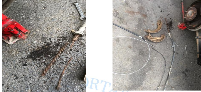
Gambar 22. Kabel rem tangan putus/macet
