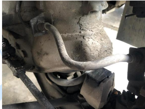
Gambar 28. Selang rem retak
