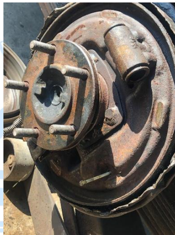
Gambar 27. Silinder roda tidak optimal
