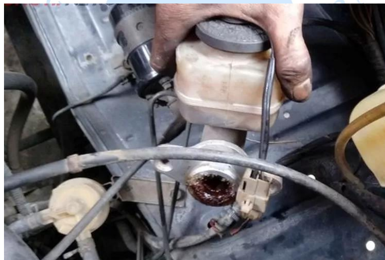
Gambar 30. Minyak rem kotor
