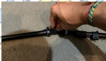
Gambar 9. Tahap menyatukan tongkat stainless steel
