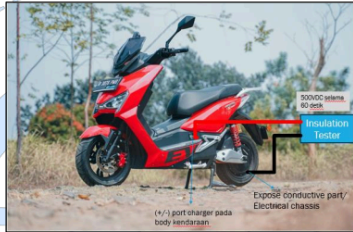
Gambar 22. Contoh pengujian Insulation tester
