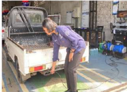
Gambar 14. Kegiatan Pengukuran pada alat uji Gaz Analyzer
