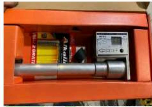
Gambar 6. Alat Uji RON BBM (Oktis-2)
