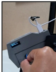
Gambar 51. Memutar Rotary Encoder Ke Kiri
