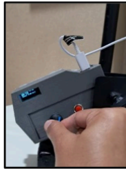
Gambar 50. Memutar Rotary Encoder Ke Kanan
