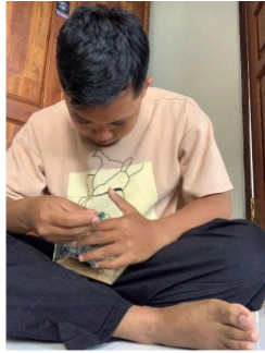
Gambar 25. Pemasangan arduino dan lcd ke akrilik box
