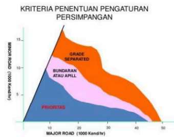
Gambar 8. Kriteria Penentuan Jenis Pengaturan Persimpangan
