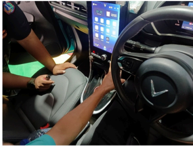
Gambar 37. Memeriksa indikator arah penggerak kendaraan
