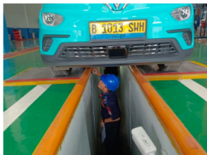
Gambar 42. Memeriksa kondisi motor traksi dan perisai kolong baterai
