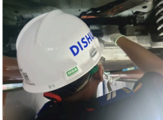
Gambar 39. Memeriksa kondisi baterai traksi atau RESS
