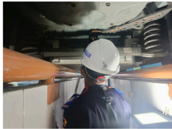
Gambar 38. Pengecekan terhadap suhu baterai, ruang suhu baterai, dan kondisi instalasi sistem pendingin baterai
