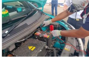
Gambar 31. Memeriksa kebocoran arus listrik ke body kendaraan
