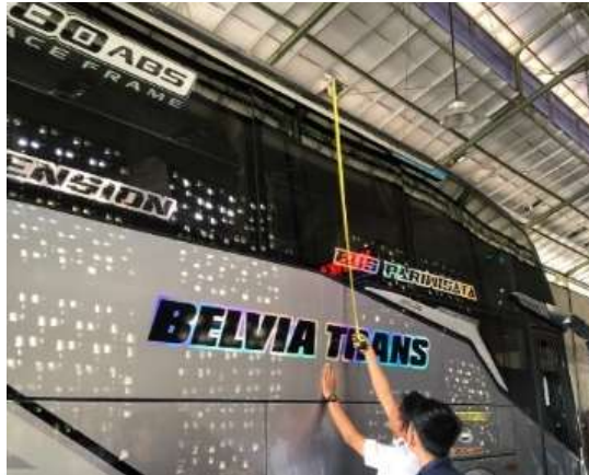
Gambar 1. Pengukuran tinggi kendaraan bus Seksi PKB Dishub Boyolali
