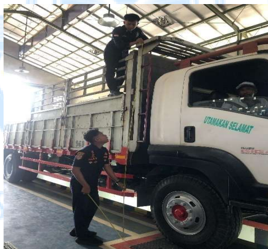
Gambar 2. Pengukuran tinggi kendaraan barang Seksi PKB Dishub Boyolali
