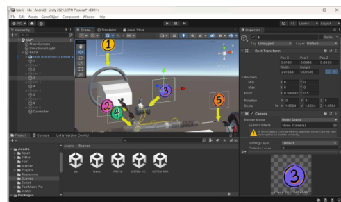
Gambar 24. Tampilan Unity dalam pembuatan button pada komponen objek 3D
