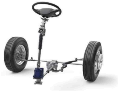
Gambar 3. Sistem kemudi recirculating ball (Sumber: otoblitz.net)
